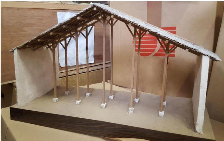
Maquette de charpente sur poteaux de bois, avec couverture en laves.
